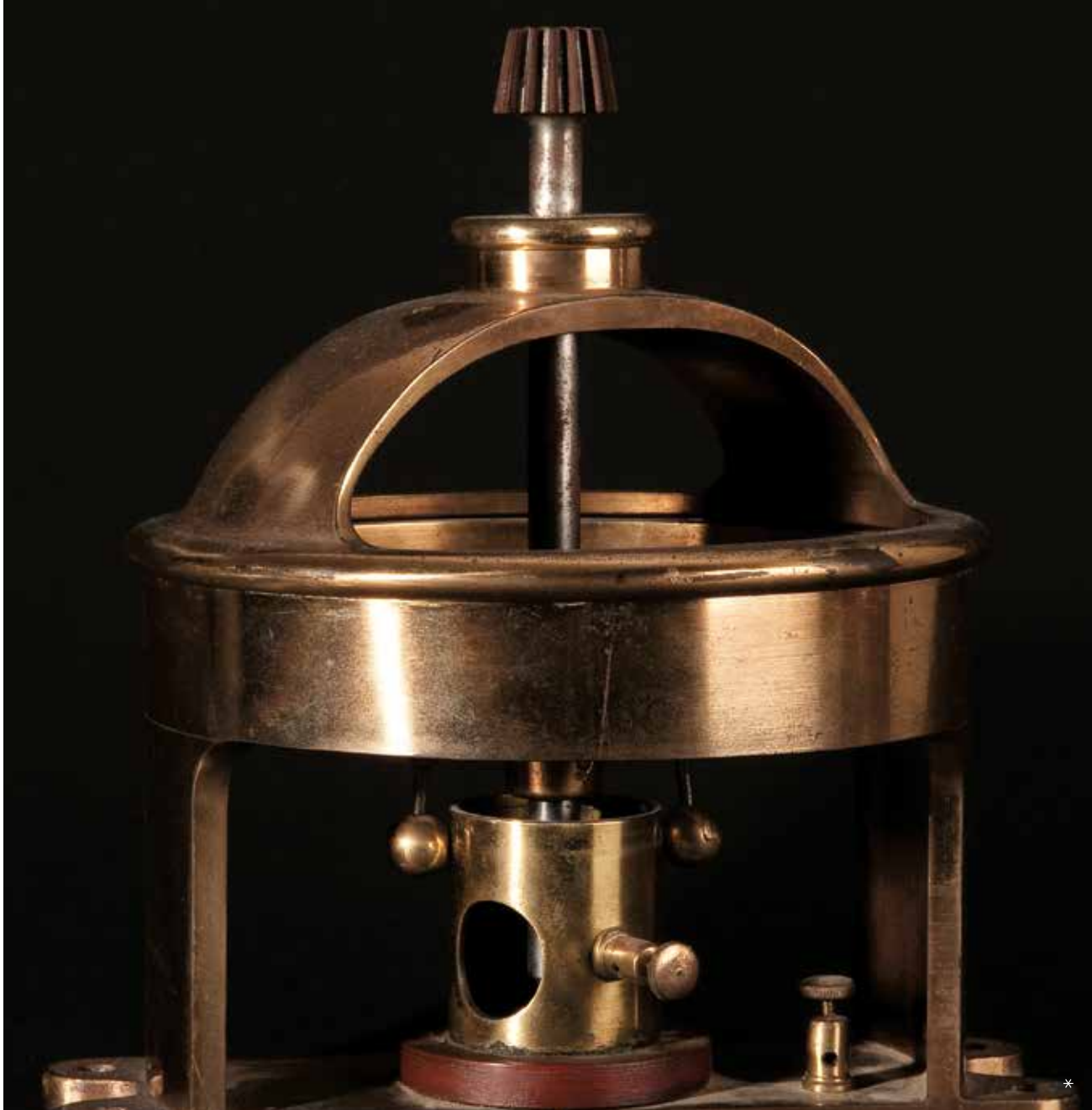
Regulador de velocidad de fricción, necesario para mantener uniforme la velocidad de giro de la óptica. Regulador de velocitat de fricció, necessari per a mantenir uniforme la velocitat de gir de l'òptica.
