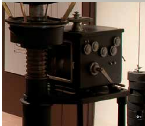
Máquina de relojería para el remonte de pesos del mismo faro. Màquina de rellotgeria per a la remunta de pesos del mateix far.
