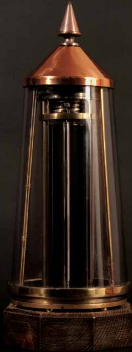
Válvula solar para el encendido y apagado automático con gas acetileno. Vàlvula solar per a l'encesa i apagada automàtica amb gas acetilè.
