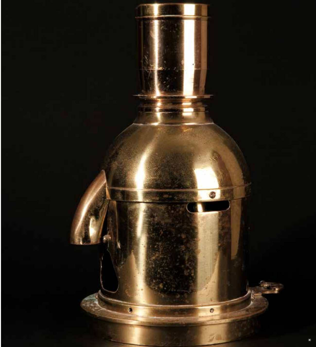
Lámpara Chance de incandescencia de vapor de petróleo. Llum Chance d'incandescència de vapor de petroli.
