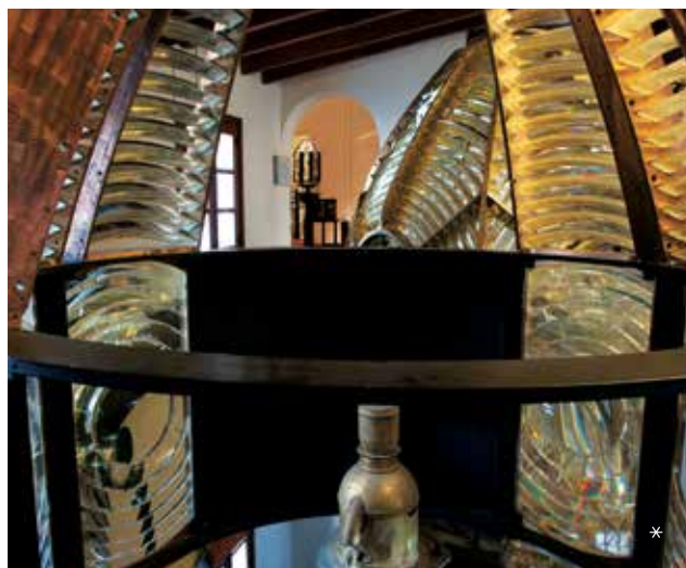
Óptica del mismo faro con flotador de mercurio construida en 1929 a partir de seis paneles de la óptica original, consiguiendo menor rozamiento y mayor velocidad de giro. Òptica del mateix far amb flotador de mercuri construida el 1929 a partir de sis panells de l'òptica original, amb la qual s'obtenia menys fregament i més velocitat de gir.
